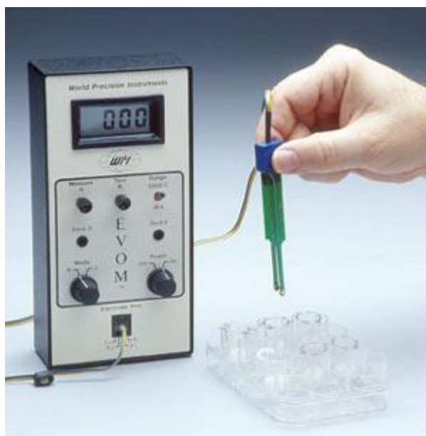
Slika 8. EVOM – uređaj za mjerenje TEER-a. Preuzeto od proizvođača – World Precision Instruments Inc. ( http://www.wpiinc.com )
