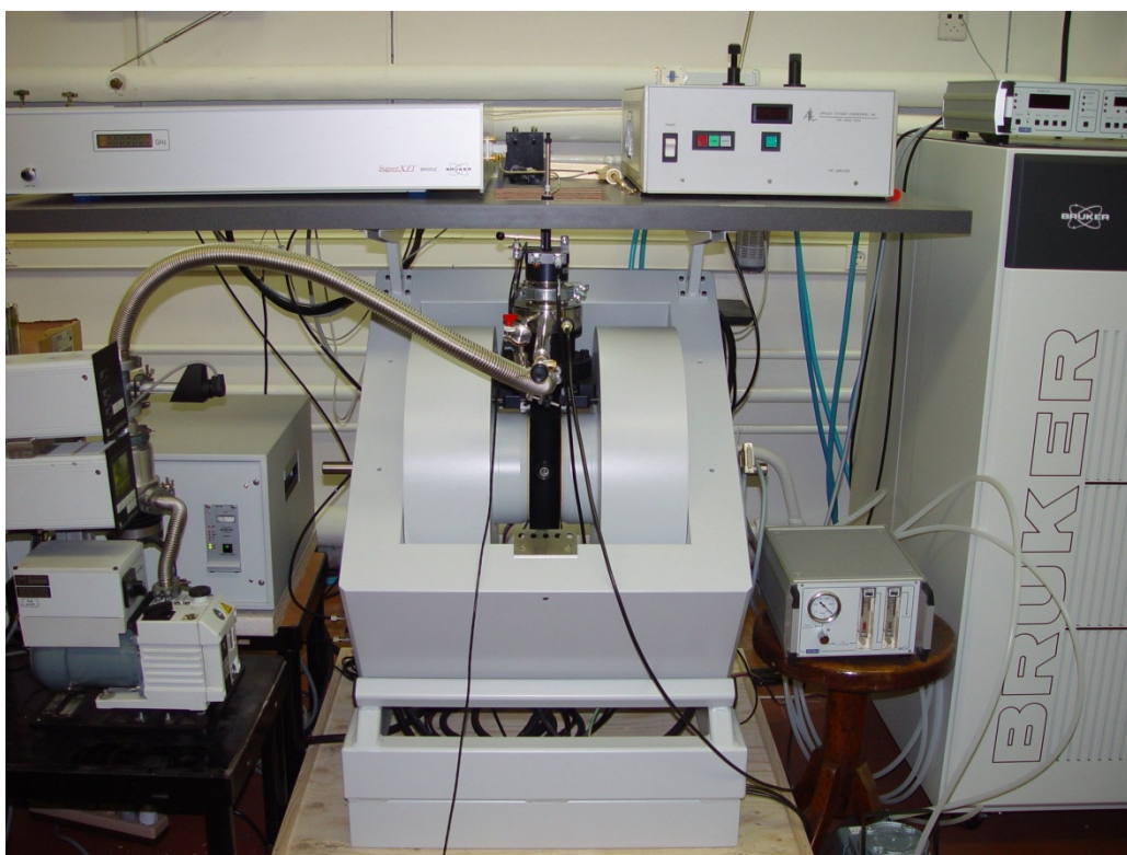
Slika 2.1. Bruker Elexsys 580 FT/CW EPR spektrometar.
